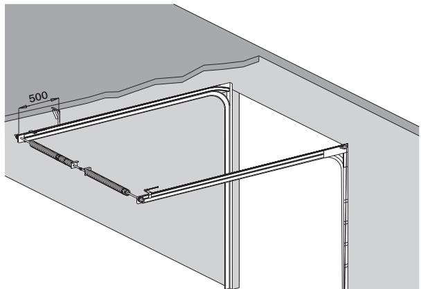
**CZ Nad výšku vrat 3 000-4 000mm nebo plochy vrat větší jak 10 do 16m<sup>2</sup>, je potřeba min. dvou horizontálních ukotvení u každé kolejnice.**
