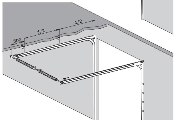
**CZ Nad výšku vrat 4 000mm nebo plochy vrat větší jak 16m<sup>2</sup>, je potřeba min. tří horizontálních ukotvení u každé kolejnice.**
