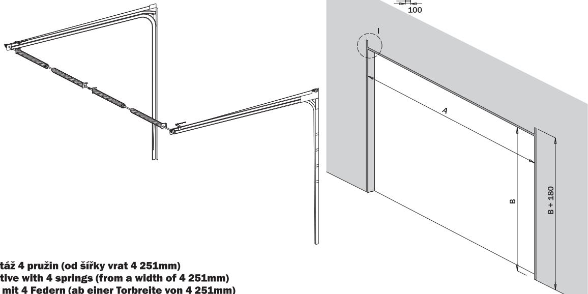
**CZ Varianta pro montáž 4 pružin (od šířky vrat 4 251mm)**
