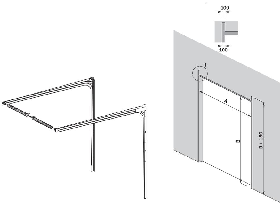
**CZ POČET A UMÍSTĚNÍ UKOTVENÍ HORIZONTÁLNÍCH KOLEJNIC**
