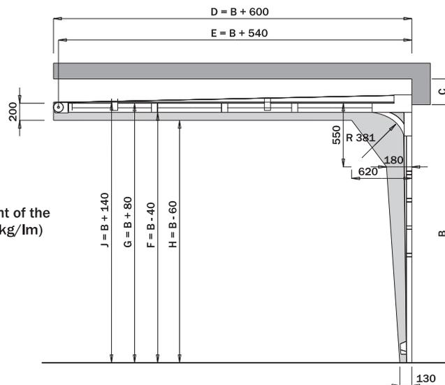
**CZ VYHRAZENÁ PLOCHA PRO VERTIKÁLNÍ KOLEJNICE + PRUŽINOVÝ SYSTÉM**
