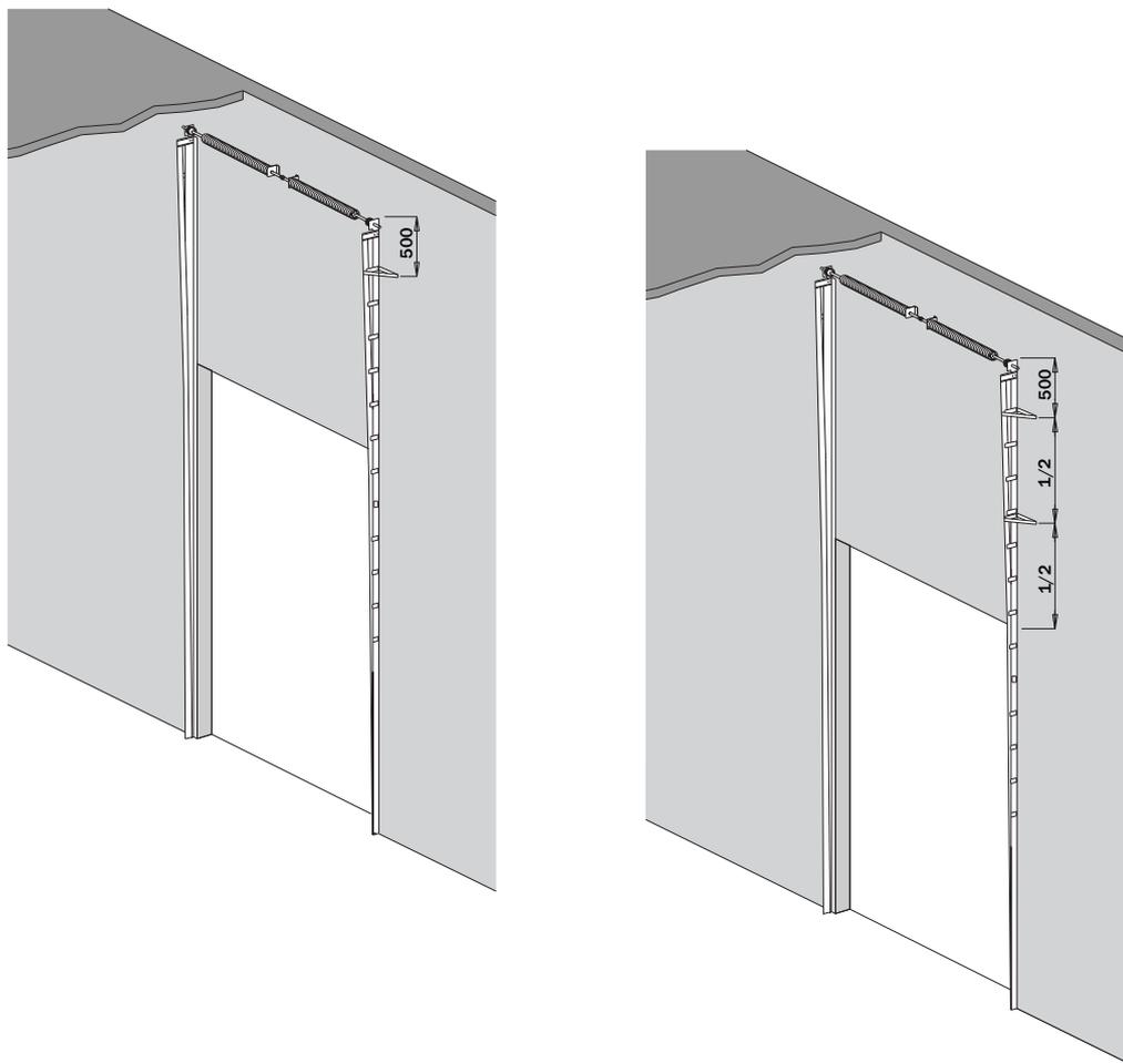
**CZ** Od výšky vrat 3 510mm je potřeba min. dvou ukotvení u každé kolejnice.
