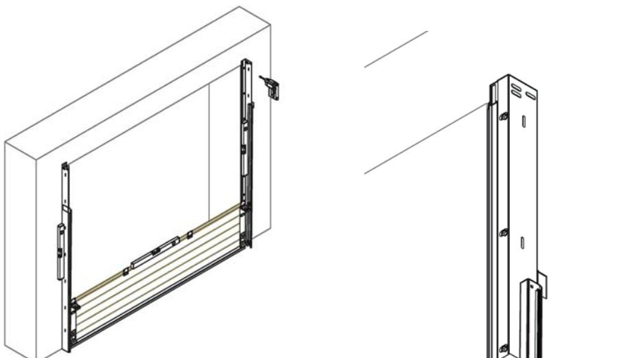
CZ Horní těsnění zkrátíme na potřebnou délku a pomocí pružinových příchytek přichytíme ke zdivu.
