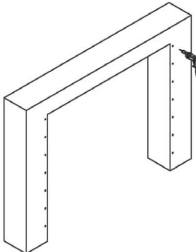
CZ Svislé kolejnice vyvážíme pomocí vodováhy a přišroubujeme.
