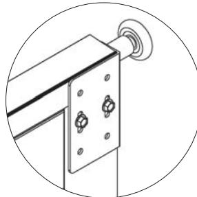
**CZ** Postupně do otvoru skládáme 2, 3 .... a horní sekci. Na horní sekci přišroubujeme horní pant tak, aby horní sekce dostatečně těsnila.
