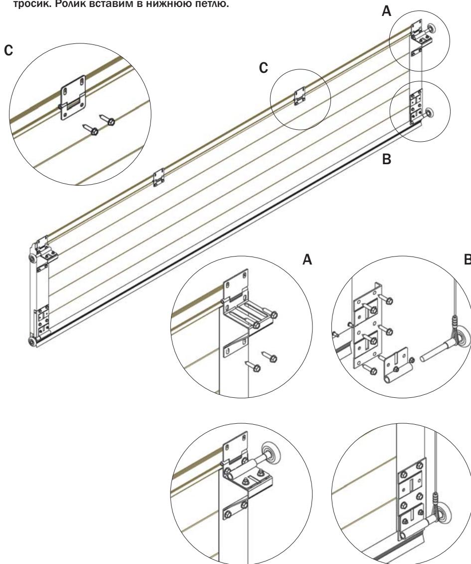
**CZ** Montáž stranových pantů 450CZ+10, středových pantů 450HZ+10, na spodní kolečko navléčeme lanko, kolečko vložíme do spodního pantu.
