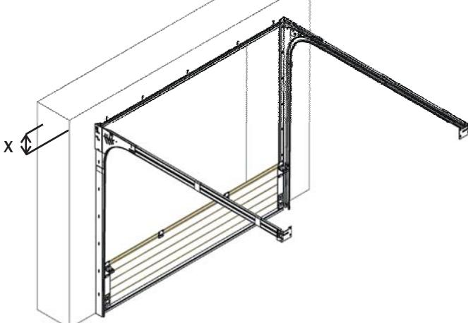
CZ Pomocí C-profilu spojíme horizontální kolejnice. C-profil přišroubujeme pomocí šroubů M8. C-profil nesmí výčnívat z horizontálních kolejnic.
