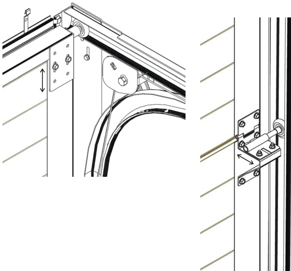
**CZ** Torzní tyč zajistíme proti protočení, pružinovými tyčemi napružíme první pružinu potřebným počtem otáček, pružinu zajistíme šrouby. U druhé pružiny postupujeme stejným způsobem.
