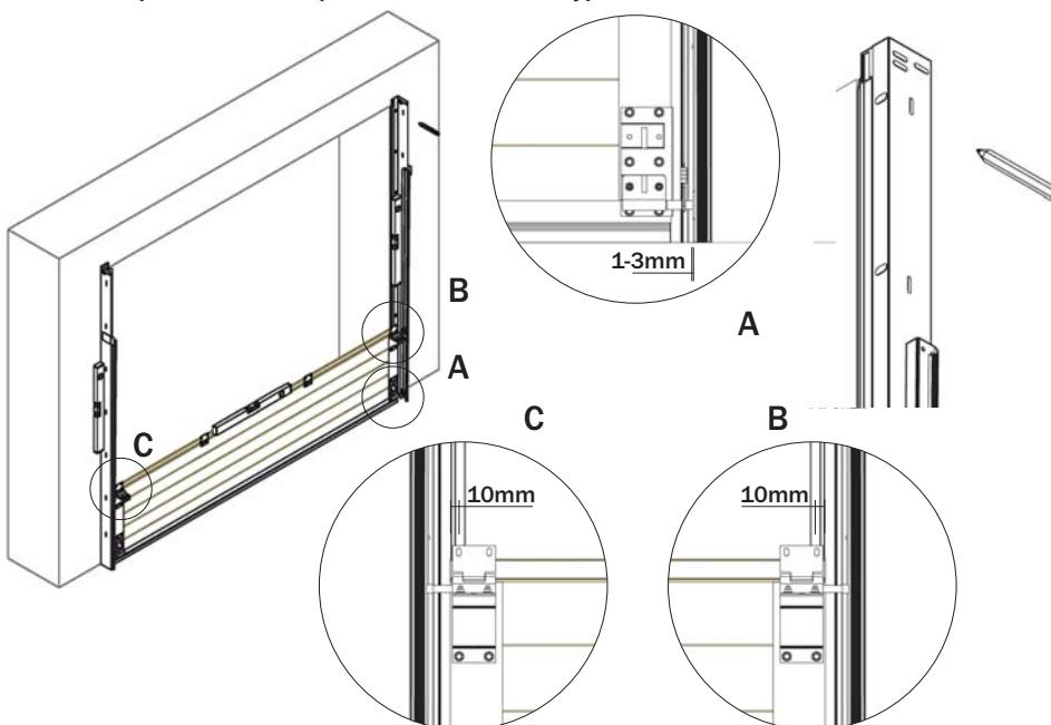
CZ Označené otvory vyvrátáme vrtákem ø12mm, do otvorů vložíme hmoždinky.
