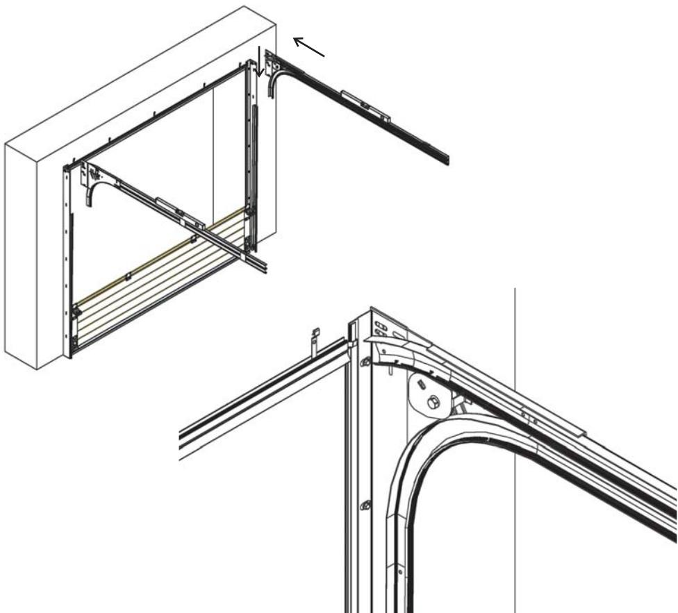
**CZ** Na konec horizontální kolejnice přišroubujeme pomocí šroubů M6 nosné konzoly C-profilu.
