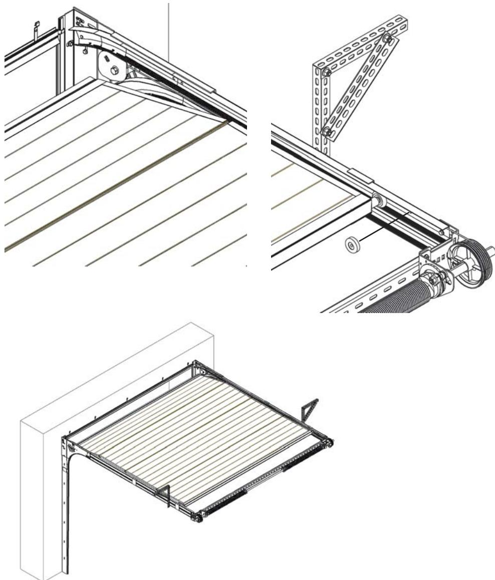
**CZ Návod na demontáž sekčních garážových a průmyslových vrat****Sekční vrata při demontáži musí být vždy v uzavřené poloze!!!****Na vratech neprovádějte demontážní práce dokud neodproužíte torzní pružiny!!!****1) Odpružení torzních pružin**
