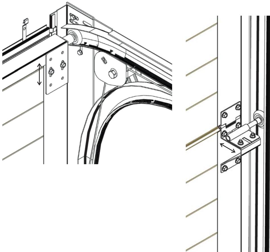
CZ Boční pant seřídíme tak, aby mezi sekcí a bočním těsněním byla vůle 1mm. Dotěsnění horní sekce docílíme posunutím horního pantu dolů nebo nahoru.
