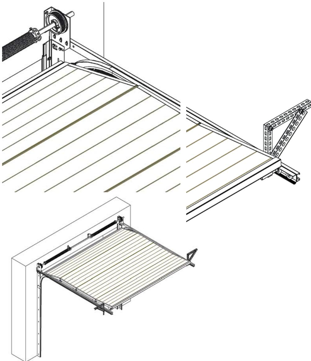
**CZ** Montáž vyztužovacího omega profilu
