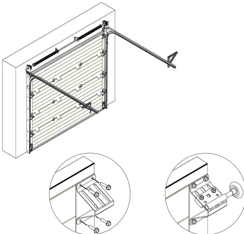
**CZ** Postupně do otvoru skládáme 2, 3 .... a horní sekci. Na horní sekci přišroubujeme horní pant tak, aby horní sekce dostatečně těsnila.
