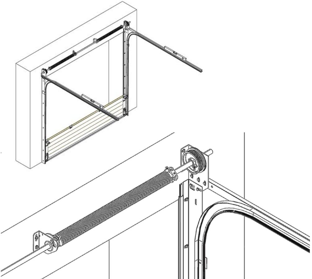
**CZ** Do seřizovacího háku spodního pantu navlečeme oko lanka. Lanko vyvedeme za spodním pantem a druhý konec přichytíme na navíjecí bubínek.
